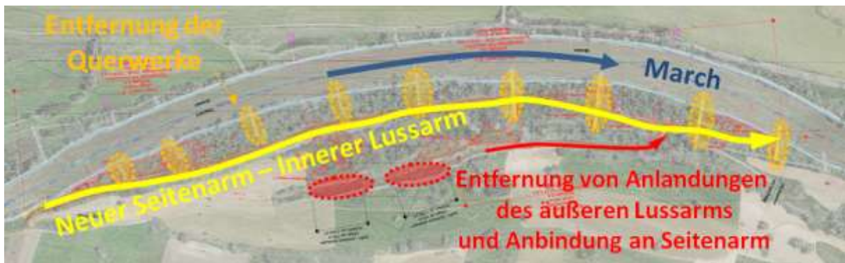
Abbildung 3: Überblick über die Wasserbaumaßnahmen im Bereich der Langen Luss
