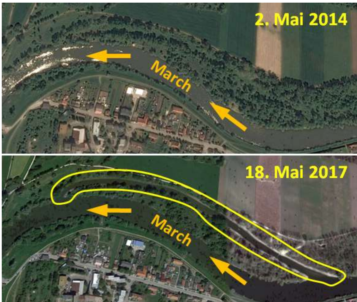
Abbildung 46: Seitenarm Angern vor (oben) und nach (unten) der Umsetzung.
