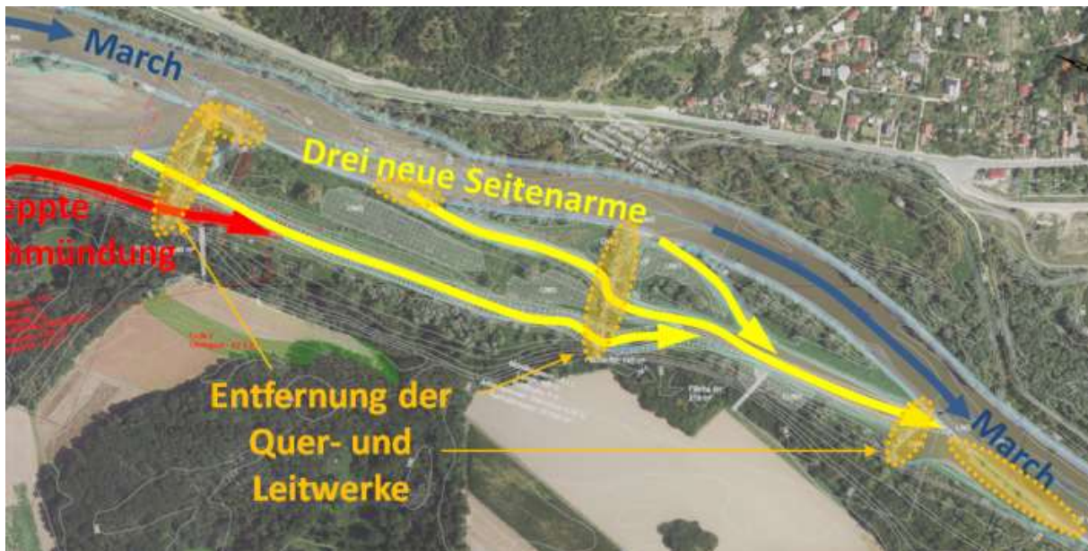
Abbildung 1: Überblick über die Rückbaumaßnahmen im March-Mündungsbereich
