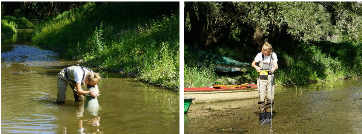
Abbildung 8. Links: Verwendung des Schauglases; hiermit können die Atemöffnungen der Najaden im Substrat gesichtet werden. Rechts: Messung der Fließgeschwindigkeit mithilfe des „Flomate“.
